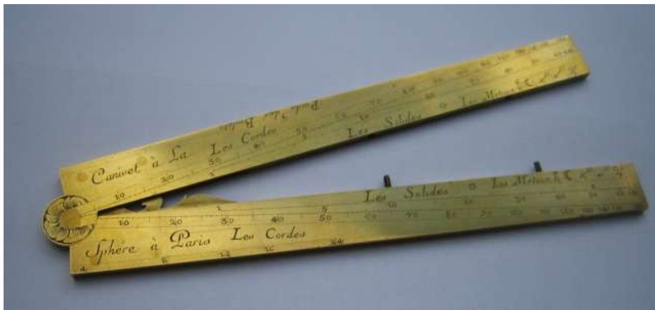
Compas de proportions de Jacques Canivet. Collection JP et N CAREL – CANIVET Photo JP CAREL 2009 Un instrument identique à celui-ci, signé Lennel a été retrouvé sur l'île de Vanikoro, en un lieu baptisé « Le camp des Français ».
